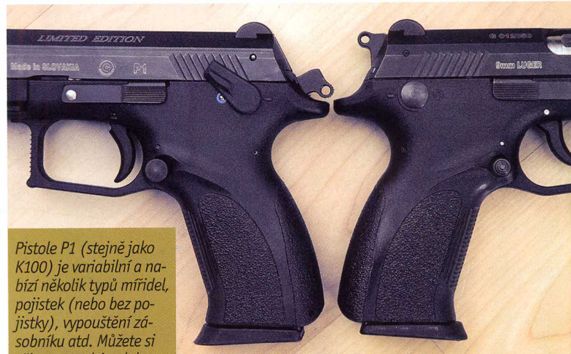
U sériové P1 přibýly přední hmatníky závěru a kvůli jiné vratné pružině je i odlišný její průchod závěrem
