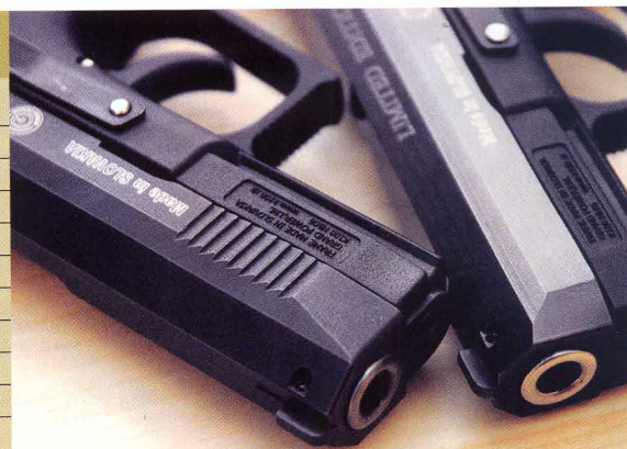
U sériové P1 přibýly přední hmatníky závěru a kvůli jiné vratné pružině je i odlišný její průchod závěrem
